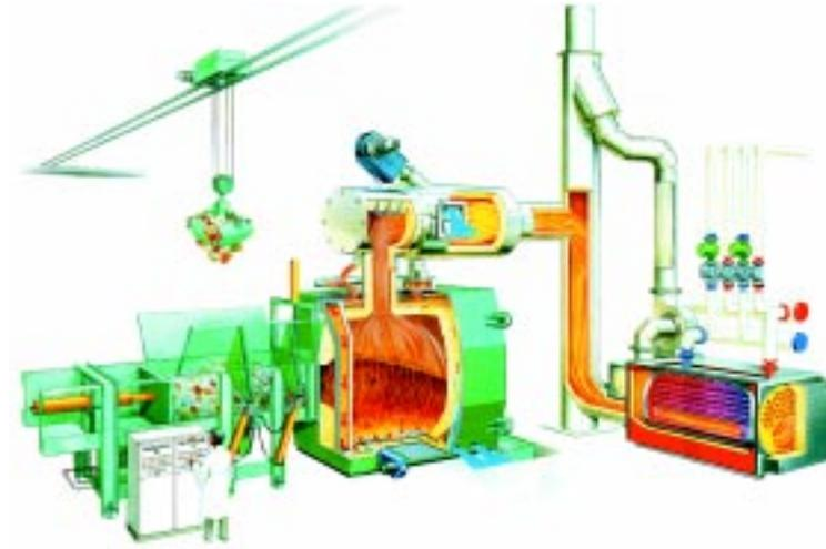
**Gráfico 4. Incinerador de doble cámara con sistema de recuperación de calor**
