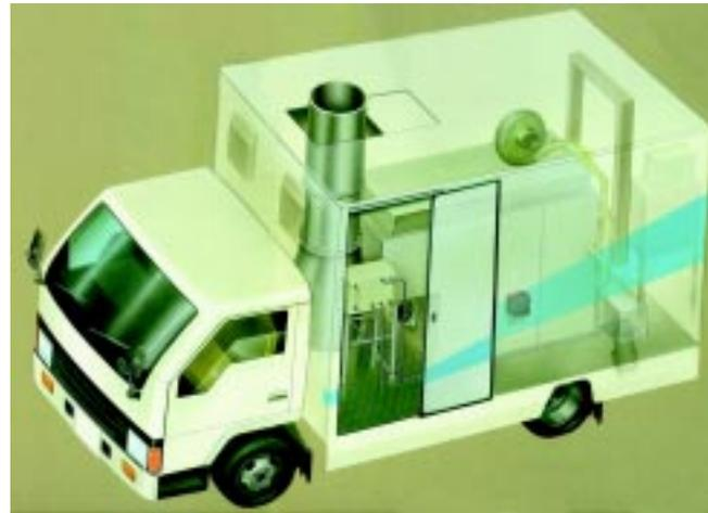
**Gráfico12. Incineración móvil dentro de una unidad especialmente acondicionada**
